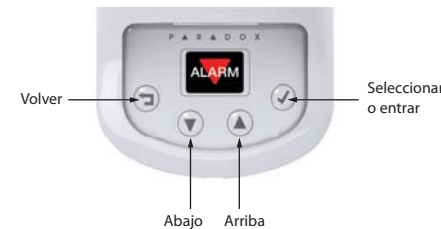
Figura 5: Botones y pantalla OLED del NVX80
